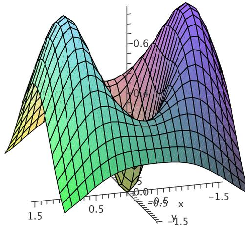
Abbildung 6.7.: Der Graph der Funktion  $f(x, y) = (x^2 + 2y^2)e^{-x^2 - y^2}$
